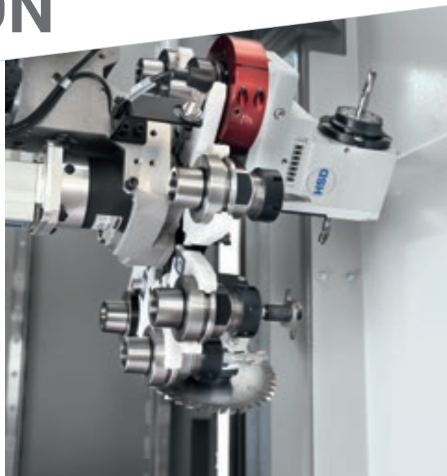
Almacén de 8 posiciones para poder gestionar diferentes tipos de agregados y aumentar así la versatilidad de la máquina.
