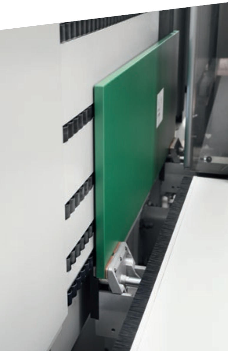
Almacén de 8 posiciones para poder gestionar diferentes tipos de agregados y aumentar así la versatilidad de la máquina.
